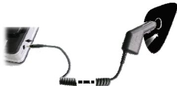
Insira o equipamento no carregador veicular após dar partida no carro para prevenir que alguma alteração de corrente elétrica danifique o equipamento.
